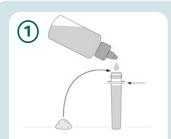
0,2 ml Flüssigkeit (oder Spülwasser) in das Extraktionsröhrchen geben oder **0,2 g** homogenisierte Probe einwiegen. Bis zur Verschlussunterkante (s. Markierung) mit Extraktionspuffer auffüllen.
