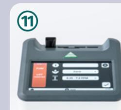
Anhand des Barcodes erkennt der Reader den verwendeten Teststreifen. Proben-ID eingeben, Matrixtyp und Quantifizierungsbereich auswählen und bestätigen.
