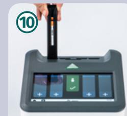
Den Teststreifen in den mitgelieferten Streifenhalter einsetzen und in den Reader stecken.
