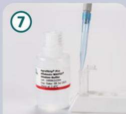
1000 µl Verdünnungslösung in ein Mikrozentrifugengefäß pipettieren.\*
