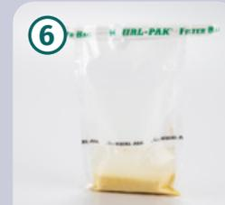
Die Probe 1 Minute absetzen lassen. Im Einzelfall für T-2/HT-2: Den Überstand der Probe bei 2000 g für 30 Sekunden zentrifugieren.
