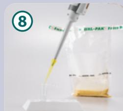
100 µl Überstand vom Probenextrakt aus dem Filterbeutel in das Mikrozentrifugengefäß pipettieren und kräftig mischen (Verhältnis 1:11).\*
