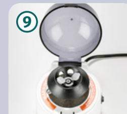
Probe für 30 Sek. bei 2000 g zentrifugieren (zweiter Schritt für T-2/HT-2). Bei einer ungeraden Anzahl von Proben ein Gegengewicht verwenden.
