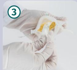
10 g einer repräsentativen, homogenisierten Probe auf eine Seite eines Whirl-Pak®-Filterbeutels geben. In die gleiche Seite einen Extraktionspufferbeutel geben.
