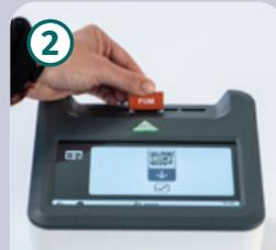
QR-Karte mit Informationen zur Testmethode in den Reader einführen. Einmal für jede Charge gespeichert, muss sie nicht noch einmal gescannt werden.
