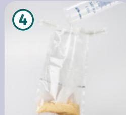
50 ml destilliertes oder deionisiertes Wasser zur Probe in den Whirl-Pak®-Filterbeutel geben.
