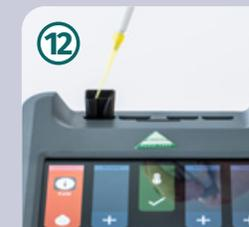
200 µl Probenextrakt in den Streifenhalter pipettieren. Der Reader startet den Assay automatisch und zeigt anschließend die Ergebnisse an.
