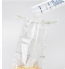
Schütteln und absetzen lassen. Für bestimmte Toxin-Matrix Kombinationen ist vorab ein zusätzlicher Zentrifugationsschritt erforderlich (siehe Validierungsliste).
