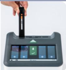
Probenextrakt in den Streifenhalter pipettieren. Der Reader startet den Assay und zeigt anschließend die Ergebnisse an.
