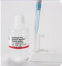
Probenextrakt in das Mikrozentrifugengefäß übertragen und für 30 Sekunden zentrifugieren.
